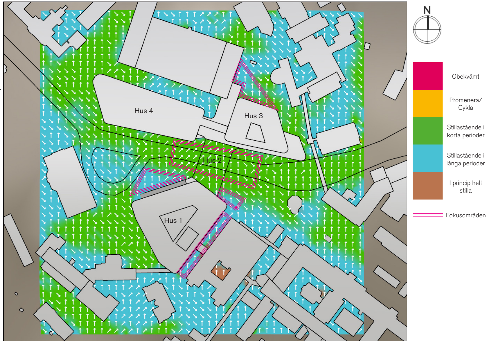
Figur 50: Marknivå: Komfort och vindriktning, vinter, utan träd.
