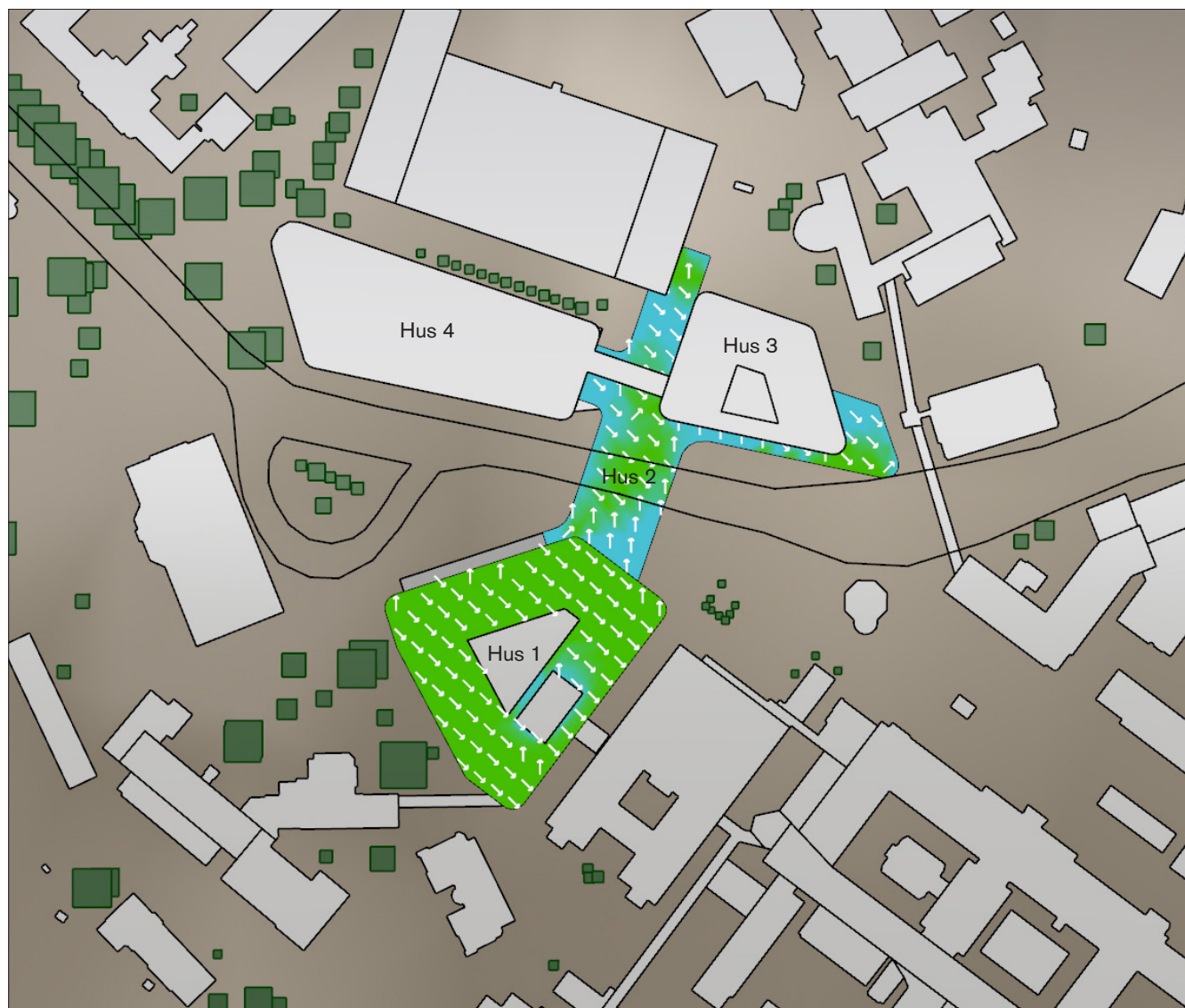
Figur 49: Taknivå: Komfort och vindriktning, sommar.
