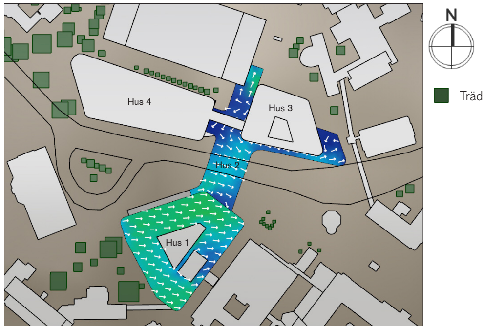
Figur 31: Taknivå: Vindriktning och hastighet, västlig vind.
