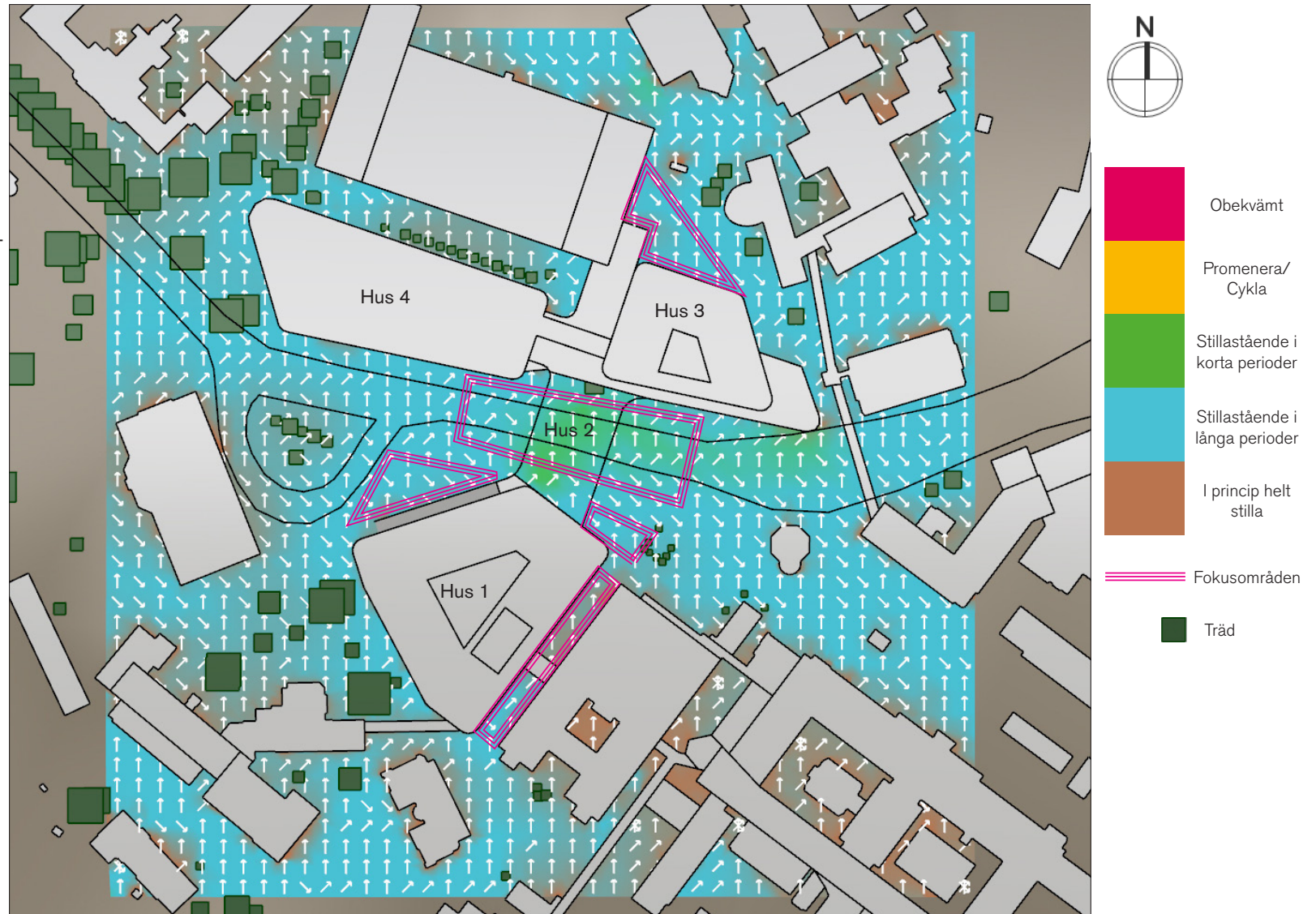
Figur 48: Marknivå: Komfort och vindriktning, sommar.
