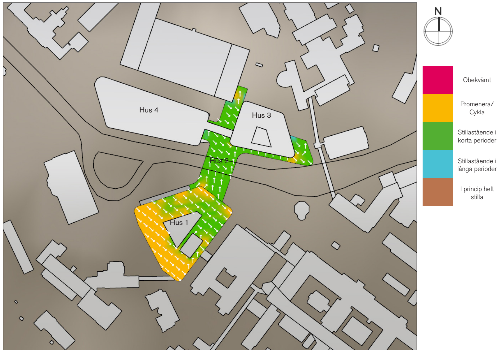
Figur 51: Taknivå: Komfort och vindriktning, vinter, utan träd.
